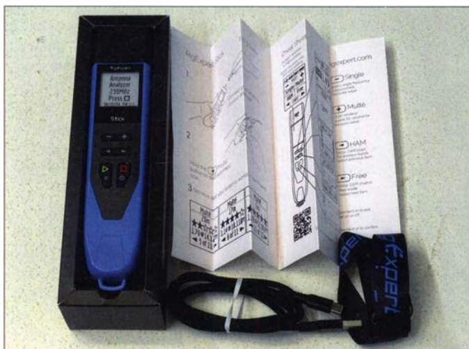
Bild 1: Antennenanalysator RigExpert Stick 230; mitgeliefert werden eine Kurzbedienungsanleitung, ein Tragegurt sowie ein USB-Anschluss- und Ladekabel. Auch im ausgeschalteten Zustand sind Geräteinformationen auf dem Display sichtbar.
