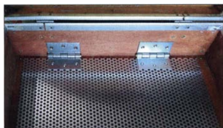
Bild 4: Befestigung der Grundplatte über Scharniere an der hinteren Kofferwand
