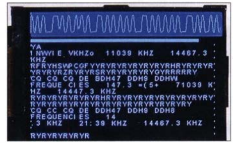
Bild 5: RTTY-Empfänger mit grafischem Display auf Basis eines Teensy-Boards
