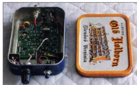
Ansicht des in einer Tabakdose eingebauten und verdrahteten Quarzmitte V1 Foto: G8TMV
