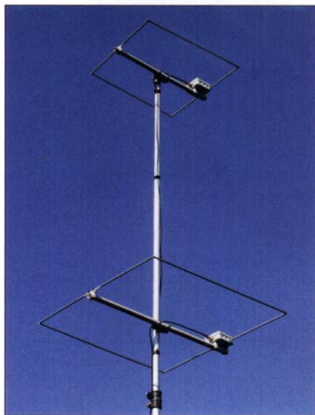
Bild 1: Halo-Antennen für 4 m und 6 m, hier übereinander am Mast angeordnet
