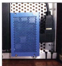
Bild 6: Der HDMI-Winkelstecker am Raspberry Pi ist mit einem Winkel vor dem Herausrutschen zu sichern.
