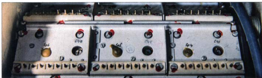
Teilansicht des Wellenschalters; an jedem Segment befinden sich 21 Kontaktstifte.
