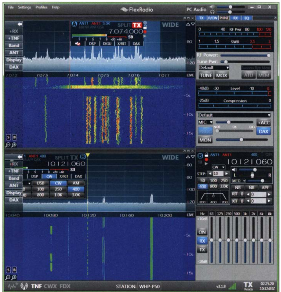
Bedienoberfläche von SmartSDR mit zwei Panadapters; die Anzeige WIDE im Spektrum erfolgt bei Überschreiten der Grenze eines Bandfilters.
