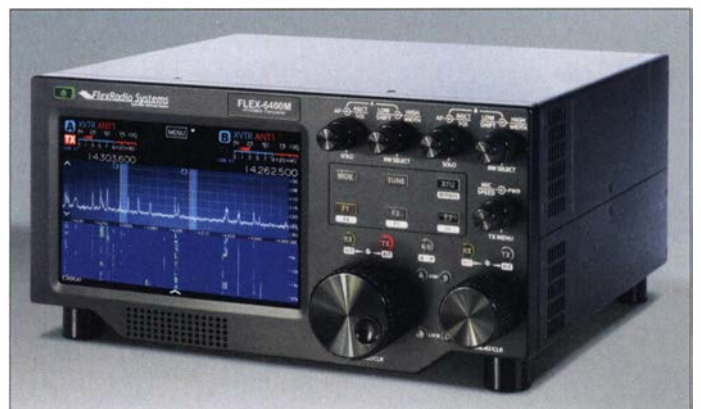
Flex-6400M im Betrieb auf dem 20-m-Band; die Darstellung von Spektrum und Spektrogramm erfolgt in einem von zwei aktivierbaren Panadaptern. Werkfoto
