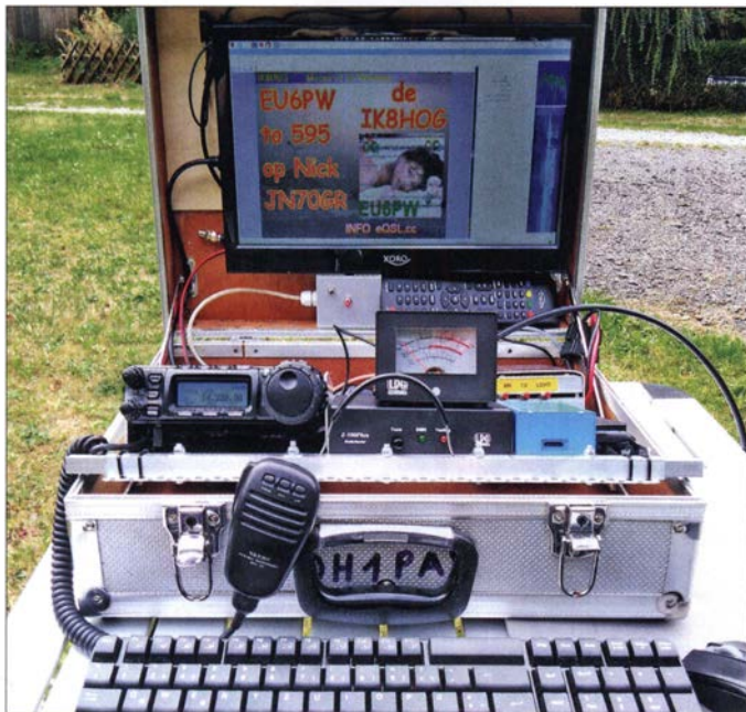
Bild 1: Funkkoffer im Einsatz; die aus der vorderen Versteifung herausgedrückten Vierkantstücke halten die angekippete Grundplatte auf den Seiten des Koffers fest.
