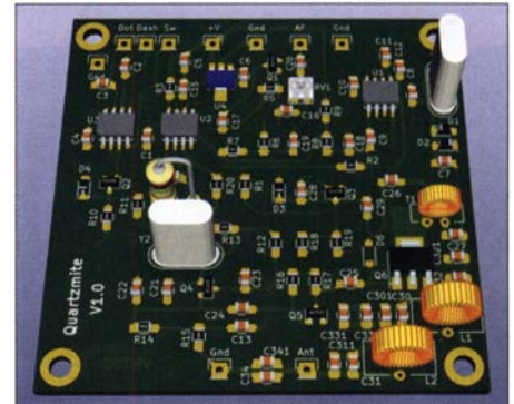
In KiCad simulierte 3-D-Ansicht der bestückten Leiterplatte des CW-Transceivers Quarzmitte V1
