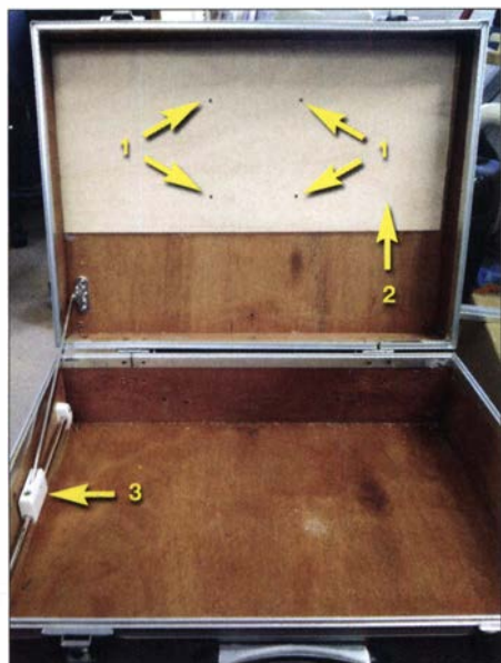
Bild 3: Bohrungen (1) und Sperrholzplatte (2) im Kofferdeckel sowie einer der Dämpfer (3)
