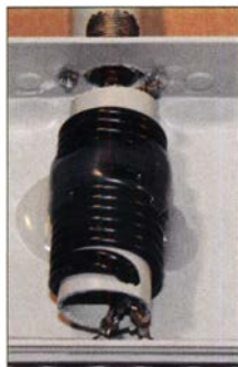
Bild 7: Speisedrossel aus zwei parallelgeschalteten RG174-Koaxialkabelstücken
